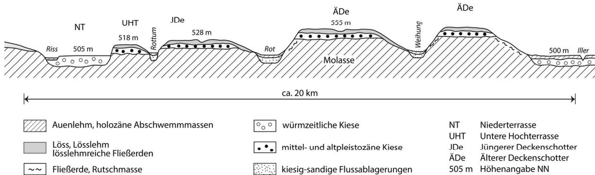
Abb. 5: Schematischer Schnitt durch die nördliche Iller-Riß-Platte.
