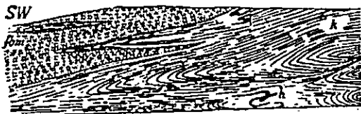
Fig. 4. Fiskalischer Kalkbruch bei Hammer—Unter-Wiesenthal, August 1915 (nach Beobachtung von F. Kossmat und R. Betzmen). Höhe über 20 m. fm = plattig-schuppiger, zwiglimmeriger Schiefergneis, k = kristalliner Kalk, h = gefalteter und terrasserter Lagergang von Amphibolit.
