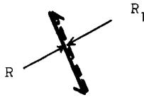
Abb. 1: Resultierende der aktiven Kräfte ( R ) und der bei stabiler Struktur auf- tretenden Gegenkräfte ( R_1 )
