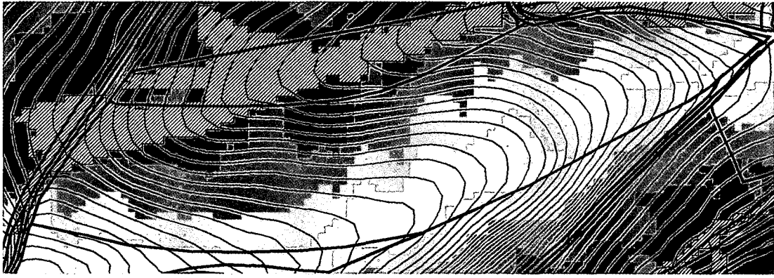
Abb.1: Faktor Relief: Lokale Einzugsgebietsgröße auf Basis des DHM5 (zunehmende Graustufe = zunehmende LEG); schraffiert mit weißem Hintergrund = (vergleyte) Kolluvisols (LEG > 50 RZ)
